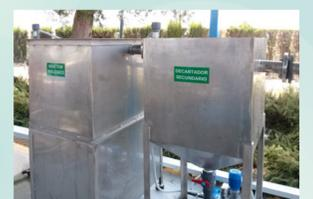
**Figura 8.** Reactor biológico y decantador secundario.
